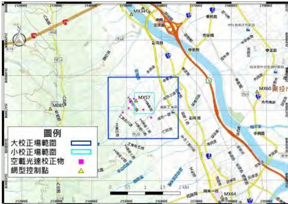
圖、藍色方框為大校正場範圍，黃三角形為 GNSS 網形控制點，粉紅色方形為光達校正物
